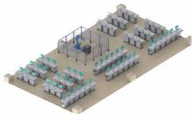
机器人理实一体化教室三维布局图
